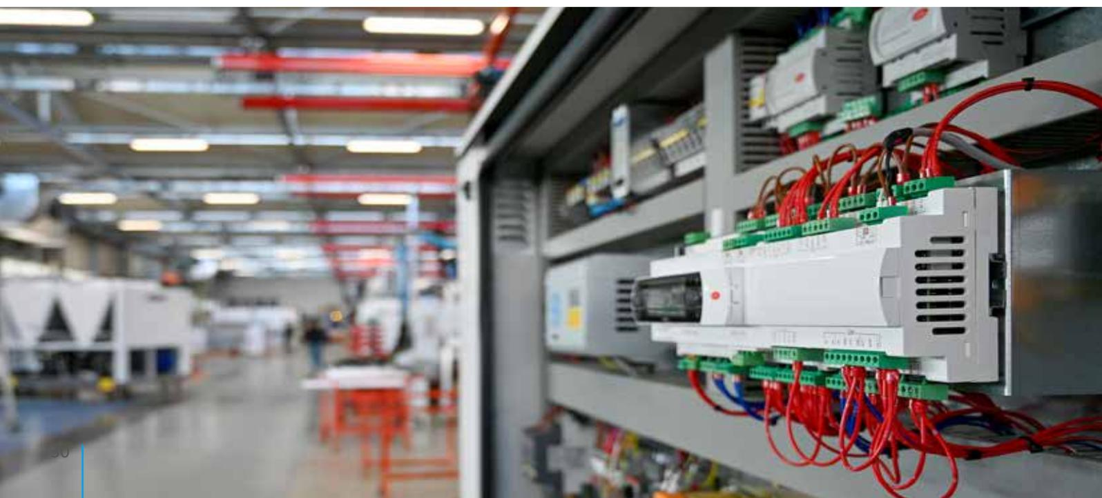
Grazie alla trentennale esperienza e a tecnici altamente specializzati, **Fast** è in grado di offrire unità di trattamento aria dotate di sistema regolazione, quadro elettrico di potenza ed elementi in campo completamente cablati e collaudati in fabbrica.
